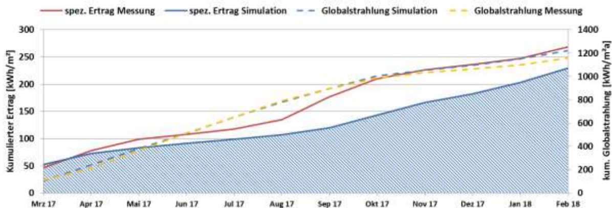
Abbildung 120: Prognostizierter und gemessener Verlauf des spezifischen Solarertrags (bezogen auf die Aperturfläche) und der Globalstrahlung für das Solarhaus Schachinger (März 2017 bis Februar 2018)
