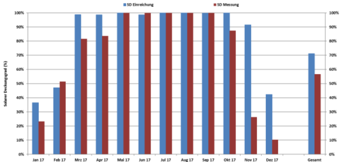
Abbildung: 104 Solarer Deckungsgrad gemäß der eingereichten Simulationsrechnung sowie gemessen für das Solarhaus Zellhofer
