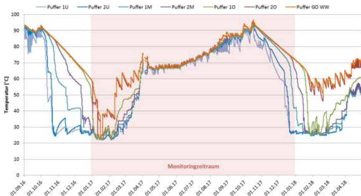
Abbildung 83: Verlauf der Pufferspeichertemperaturen der Anlage „Solarhaus Wieder“ (September 2016 bis April 2018)
