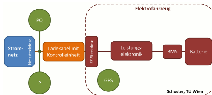
Abbildung 1: Messaufbau im und um das Elektrofahrzeug
