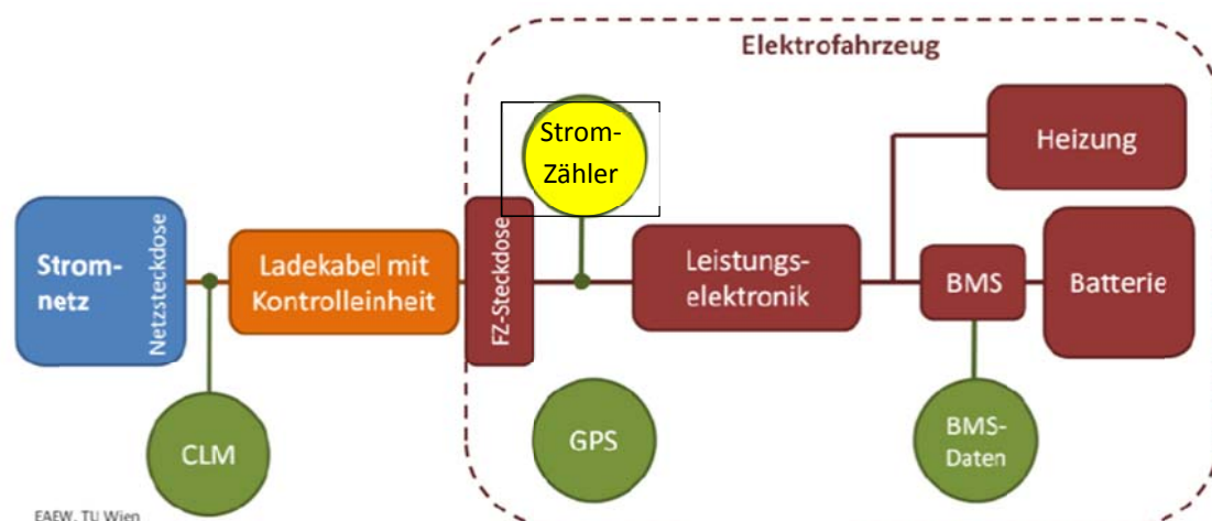
Abbildung 2: Messschema für die Langzeitmessung (Quelle: Leitinger, Schuster, Brauner | TU Wien)
