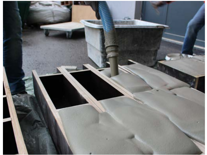
Erste Versuche mit neuartigen Betonformulierungen, die eine bessere Wärmedämmung bewirken, wurden bereits durchgeführt; Foto: Smart Minerals GmbH
