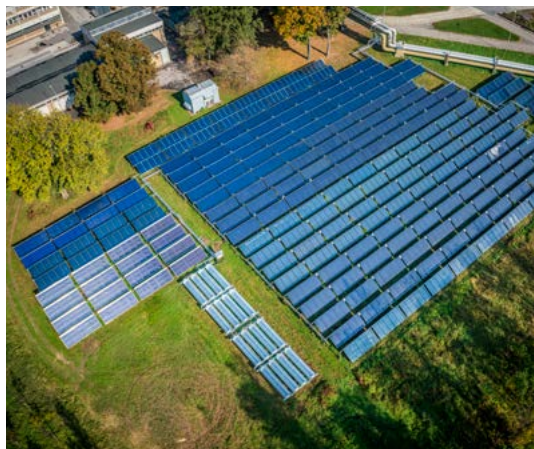
Kollektortest von verschiedenen Kollektortypen mit 3.123 m 2 zur solaren Fernwärmeeinspeisung am Fernheizwerk Puchstraße in Graz, Österreich, Foto: S.O.L.I.D.
