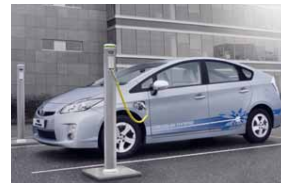
Der Prius Plug-In ist das erste Hybridfahrzeug mit größerer elektrischer Reichweite, dass auch extern aufgeladen werden kann. Foto: Toyota
