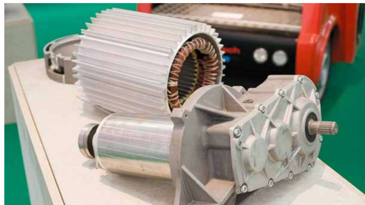
Der verhältnismäßig einfache Aufbau eines Elektromotors. Foto: Bill Lorenz
