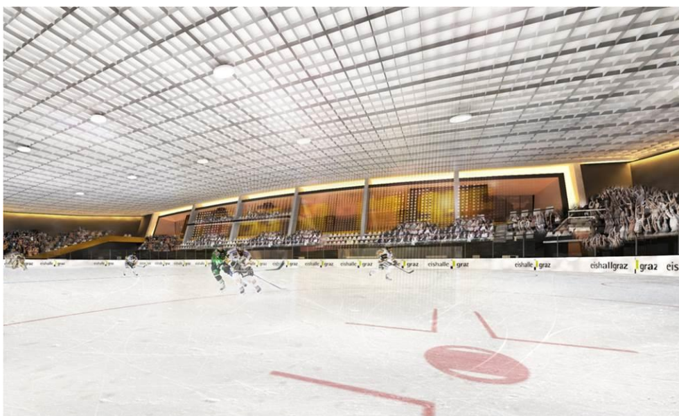
Abbildung 6: HD-TV taugliche LED-Spielfeldbeleuchtung der Merkur Eisarena Graz (Quelle: Stadion Graz Liebenau Vermögensverwertungs- und Verwaltungsgesellschaft mbH)
