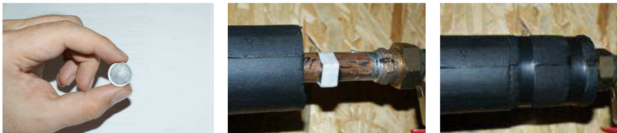
Abbildung 7: Minitemperaturdatenlogger wie sie im gegenständlichen Projekt zum Einsatz kamen bzw. wie sie montiert wurden.
