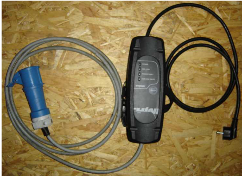
Abb. 2: Für die Beschränkung des Ladestromes wird bei einer Mode 2 Ladung eine „In-Cable Control Box“ verwendet.
