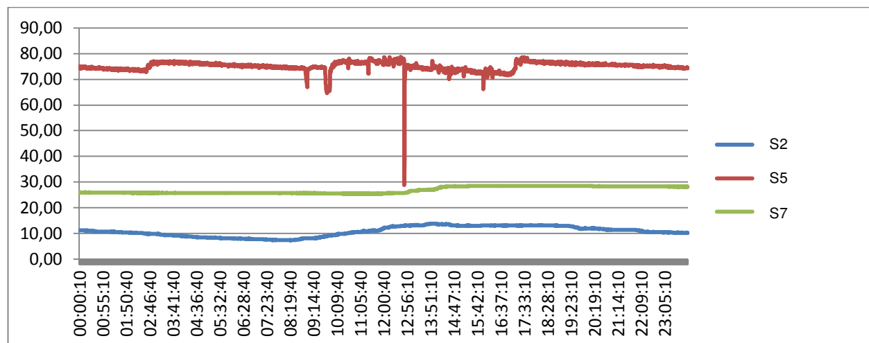
Abbildung 101: Daten aus Winsol im Laufe eines Tages mit Außentemperatur (blau – S2), Temperatur der oberen Schicht im kleinen Speicher (200 Liter) (rot – S5), Temperatur der oberen Schicht im großen Speicher (1500 Liter) (grün – S7); (X-Achse: Zeit [hh:mm:ss], Y-Achse: Temperatur [°C]).
