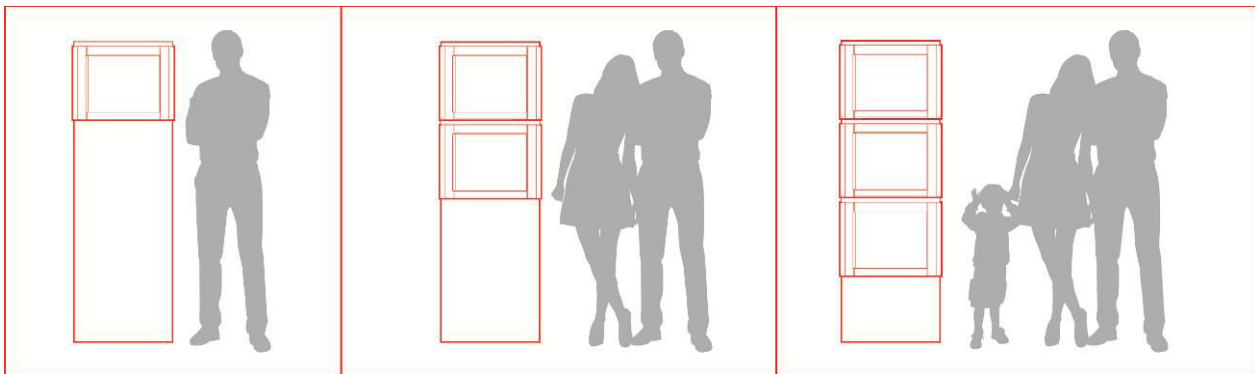
Abbildung 57: Flexible Kapazität des Kühlschranks je nach Nutzeranforderungen
