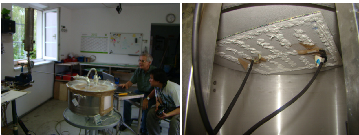
Abbildung 46: Links: Vormuster der von der GrAT entwickelten Kühlkammer; rechts: Der Verdampfer des Vormusters von unten gesehen. Die beiden schwarzen Kabel sind Sensoren zur Messung der Temperatur.
