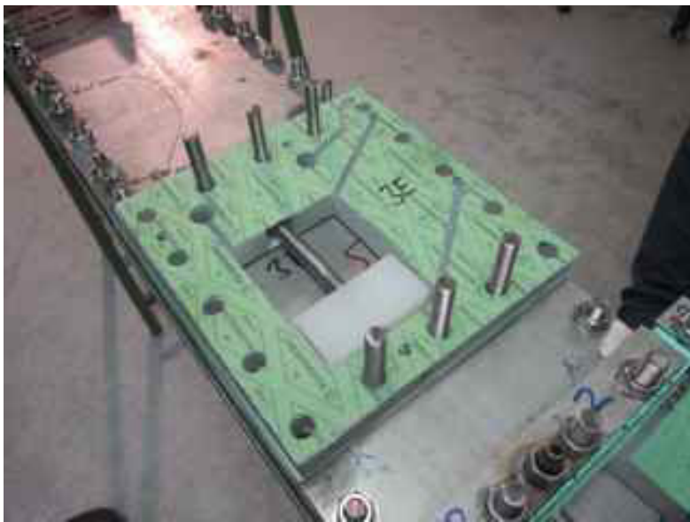
Abbildung 24: Das gleiche Gasventil von Abbildung 21, in das Plattensystem einer Ventilbox eingebaut
