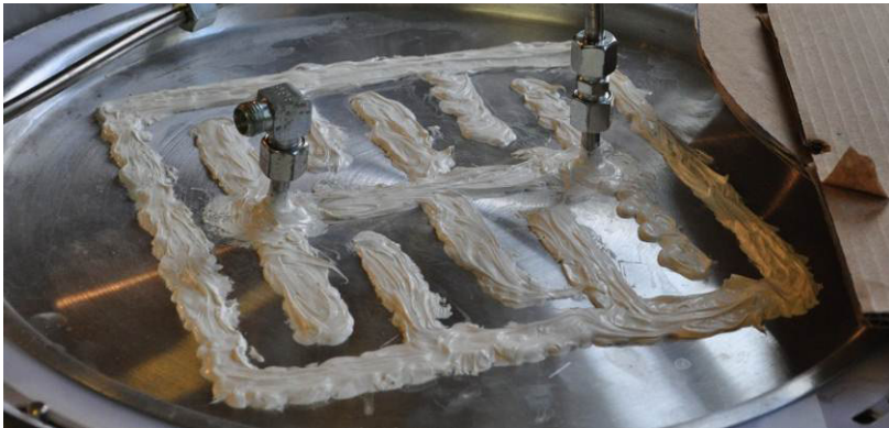
Abbildung 80: Verbindung der Verdampferplatten mit Kleber
