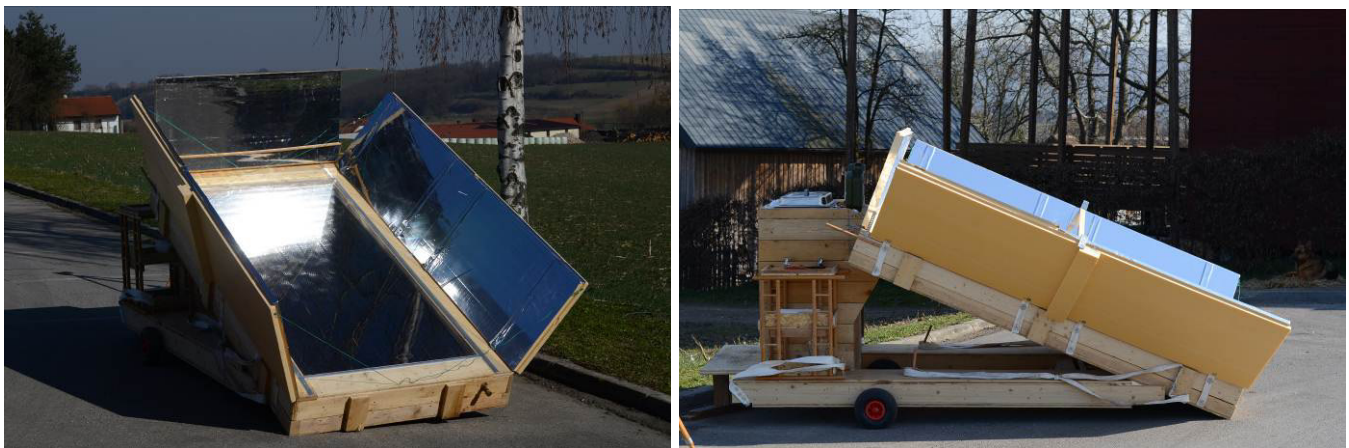
Abbildung 106: Mobiler indirekt betriebener Solarkocher/-cooler (GrAT)
