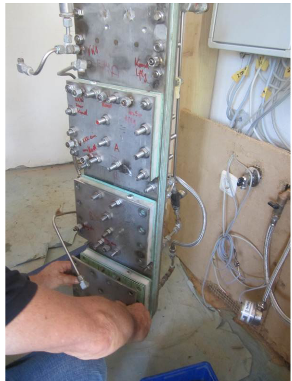
Abbildung 95: Links: Schichtweise Montage der einzelnen Module; rechts: Position der Anschlussleitungen
