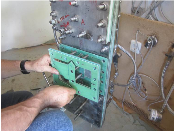
Abbildung 95: Links: Schichtweise Montage der einzelnen Module; rechts: Position der Anschlussleitungen
