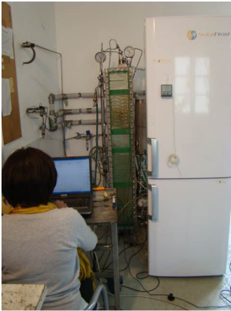
Abbildung 44: Das Vormodell der 500W-Maschine mit Acrylglasfenster in Verbindung mit dem Eudora-Kühlschrank
