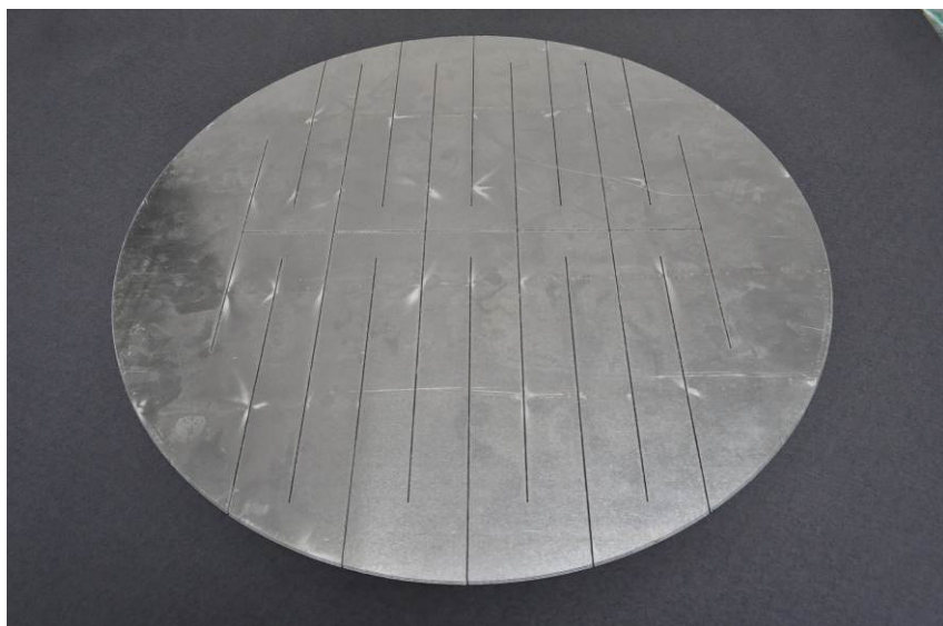
Abbildung 82: Verdampfer-Prototyp aus Aluminium (3 Platten)
