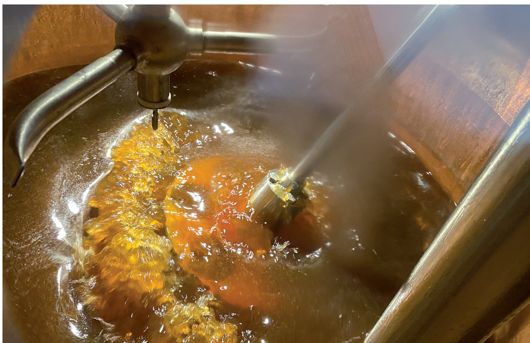
Der eigens entwickelte und patentierte FLECKS Mixer benötigt 50% weniger Energie als herkömmliche Rührwerke.
