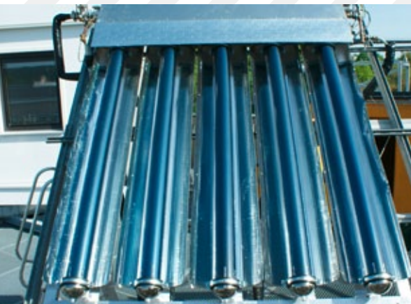
Sorptionskollektor am Labor von AEE INTEC Foto: AEE INTEC
