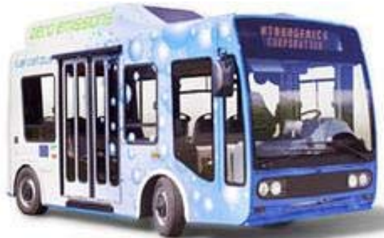
Abbildung 41: Midi-Bus des Herstellers „TecnoBus“ mit Brennstoffzelle als „Range Extender“
