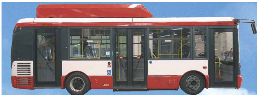
Abbildung 42: Midi-Bus des Herstellers „Rampini“ mit Brennstoffzelle als „Range Extender“
