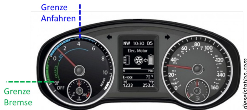
Abbildung 14: Leistungsanzeige links im Armaturenbrett des VW Jetta Hybrid
