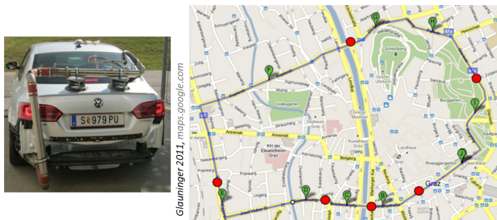
Abbildung 13: Abgasentnahme am Jetta und Messrunde in Graz
