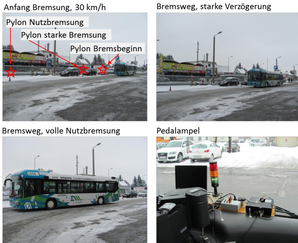
Abbildung 39: Bremsübung mit dem Hybridbus, Pedalampel (u. r.) Am Messtag waren die Strassen schneefrei, nur der Betriebshof nicht komplett geräumt.
