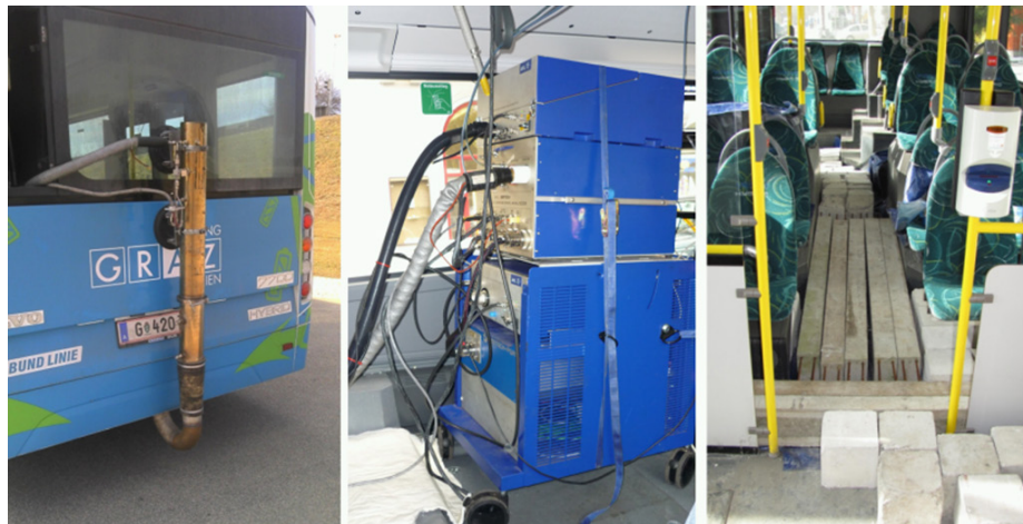
Abbildung 5: PEMS Abgasstrecke (l.), Abgas-Analysegeräte (m.), Ballast (r.) (Blassnegger, 2012-11)
