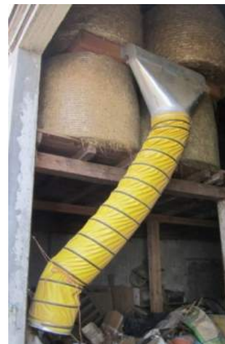
Abbildung 107: Luftverteiler für die Strohtrocknung. Quelle: AIT
