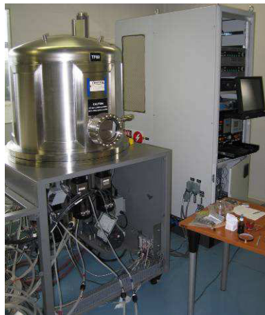
Abb. 4: Anlage zur Herstellung der Frontschichten
