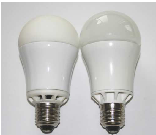
Abbildung 19: Erster 60W Prototyp der LED-Lampe während des Projekts hergestellt (links) vs. Massenproduktions-Retrofit - Lampe (rechts)
