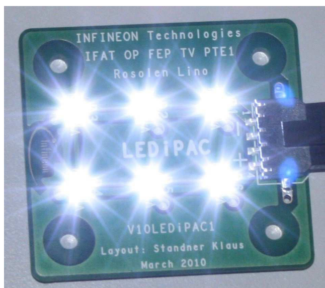
Abbildung 13: Fertige Platine mit Mustern der Demonstratorscheiben
