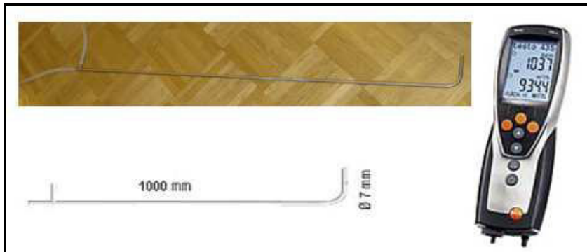
Abbildung 11: Messgerät zur Messung von Abgastemperatur und -volumenstrom (links Prandtlrohr)
