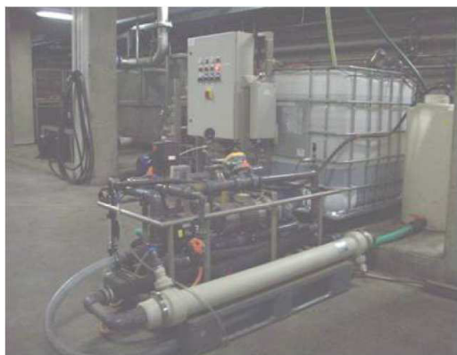
Abbildung 4: Pilotanlage – Membranfiltrationsversuche unter realen Betriebsbedingungen
