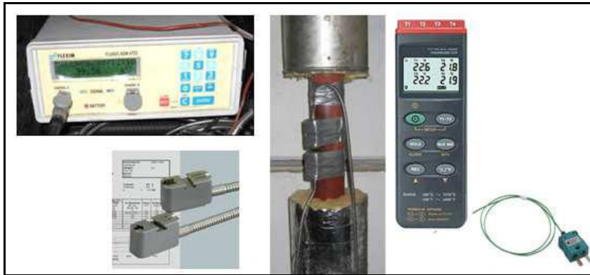
Abbildung 13: Messgeräte zur Volumenstrom- und Temperaturmessung von Flüssigkeiten
