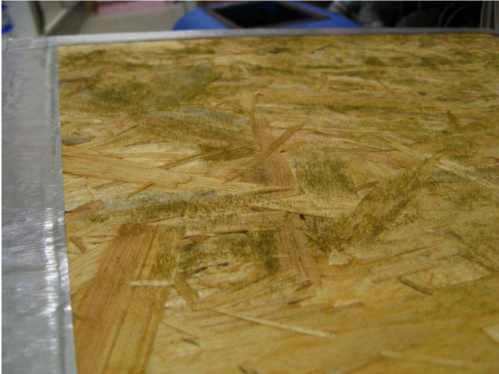
Abbildung 42: Schimmelbefall auf der Vorderseite nach 125 Tagen bei etwa 90 %rF
