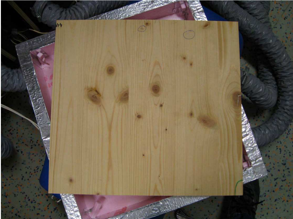
Abbildung 40: Schimmelbefall auf der Rückseite (markierte Stellen)nach 125 Tagen.
