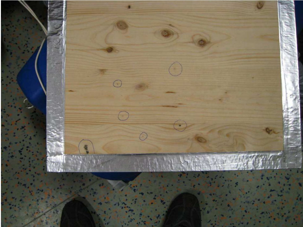
Abbildung 39: Schimmelbefall auf der Vorderseite(markierte Stellen) nach 125 Tagen.
