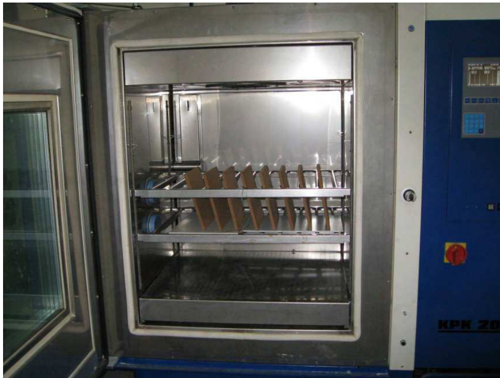
Abbildung 32: Anordnung der Proben im Klimaschrank
