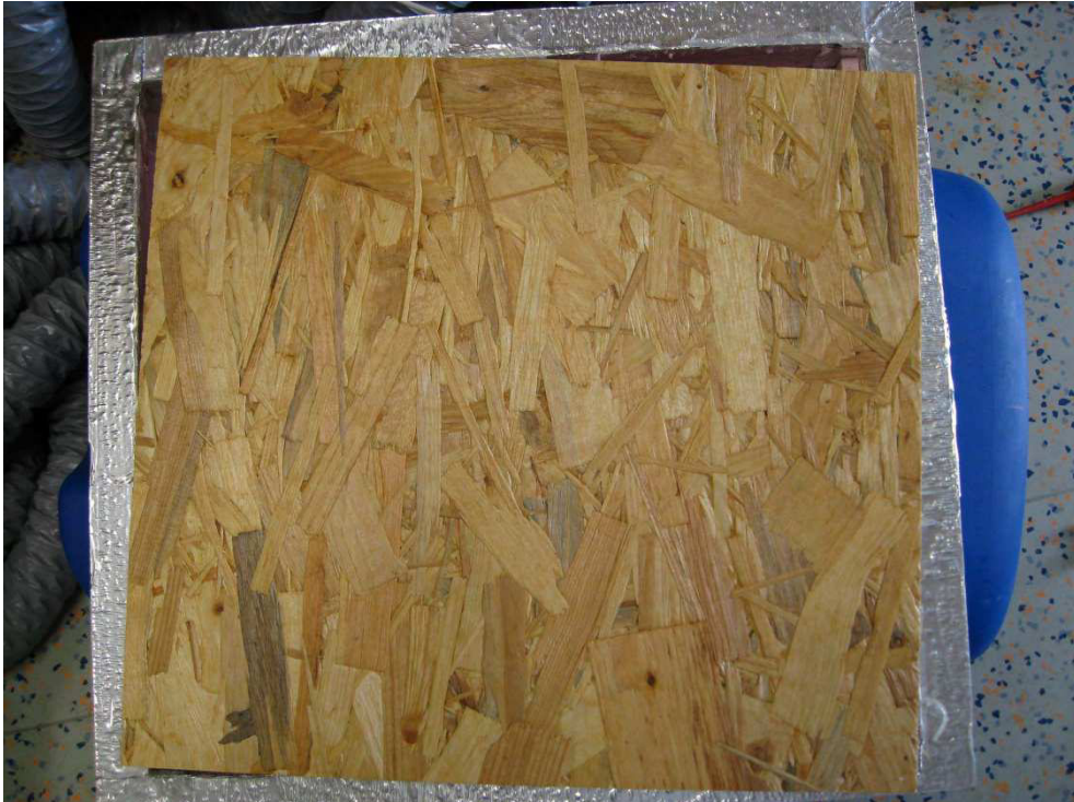
Abbildung 43: Rückseite der OSB-Platte nach 125 Tagen bei etwa 90 %rF
