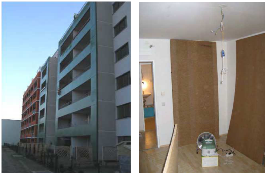
Abbildung 62: Wohnhaus in dem eine Wohnung für Versuchszwecke bereitgestellt wurde (links) und Erhöhung der Feuchtepufferwirkung eines Raumes durch ca. 50m 2 2cm dicke Weichfaserplatten (rechts)
