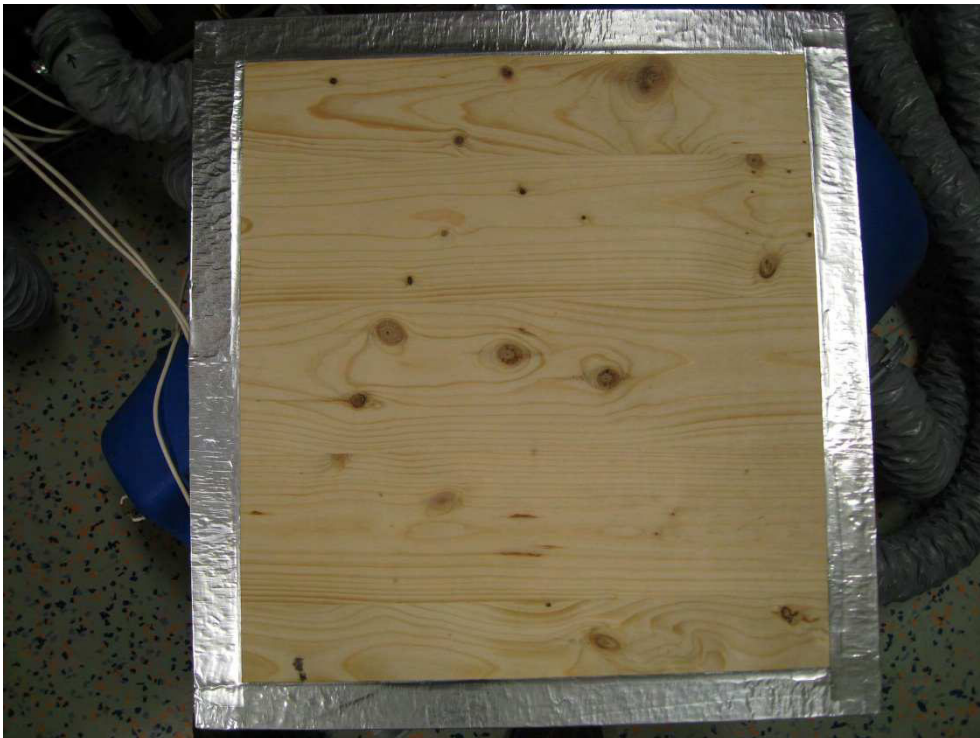
Abbildung 38: Vorderseite der Schichtholzplatte nach 125 Tagen bei etwa 90 %rF.
