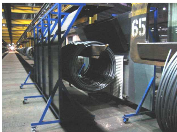
Abbildung 3: Versuchsanlage im Produktionsfluss mit Reflexionswand
