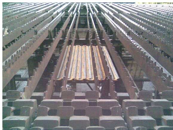
Abbildung 10: Installierte Versuchsanlage unter dem Hubrechenkühlbett im Nahtlosrohrwalzwerk
