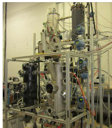
Abbildung 11: Anlagenschema und Aufbau der einstufigen Absorptionskältemaschine im Labor
