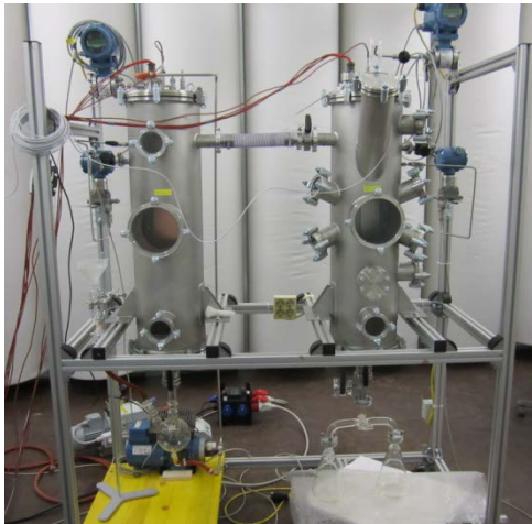
Abbildung 2: Schema und Aufbau der Versuchsanlage zur Leistungsbestimmung der neuen Absorptionslösungen
