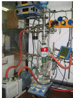
Abbildung 6: Messapparatur zur Bestimmung des Wasserpartialdampfdruckes
