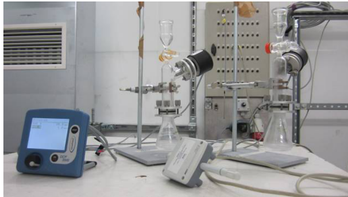
Abbildung 4: Messaufbau für die Bestimmung der Konzentration über den Dampfdruck. Als Referenzsystem wurde destilliertes Wasser verwendet.
