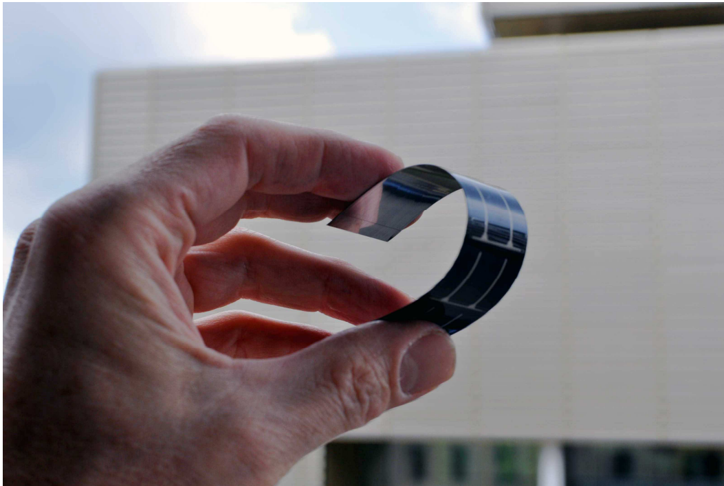
Abbildung 4: Flexible amorphe Solarmodule zwischen ETFE Folien (eigene Aufnahme)
