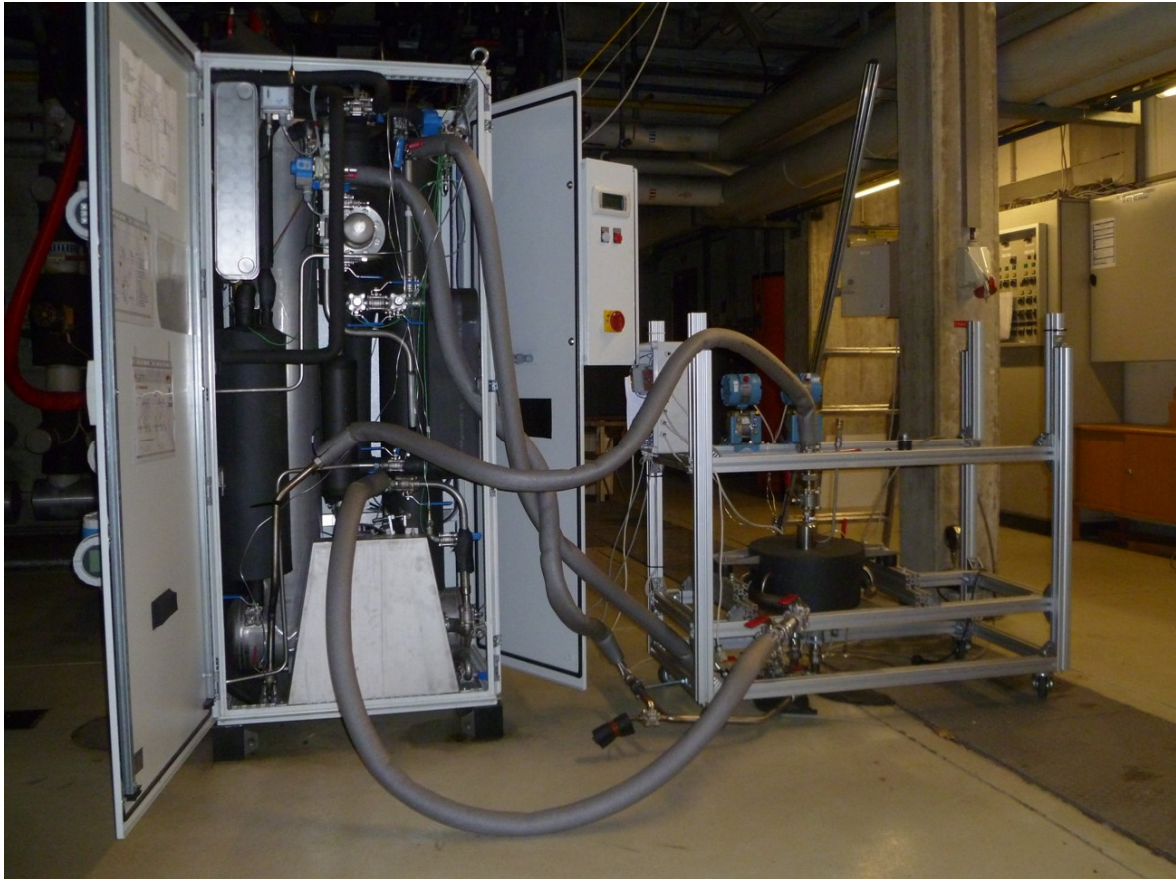
Abbildung 32: Fotos des ThermoPump-Versuchsstandes - links: modifizierte PinkChiller PC 19 und rechts: ThermoPump-Funktionsmuster mit entsprechender Messtechnik
