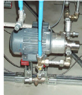
Abbildung 8: Zahnradpumpe der Fa. Scherzinger (Safarik, 2003)
