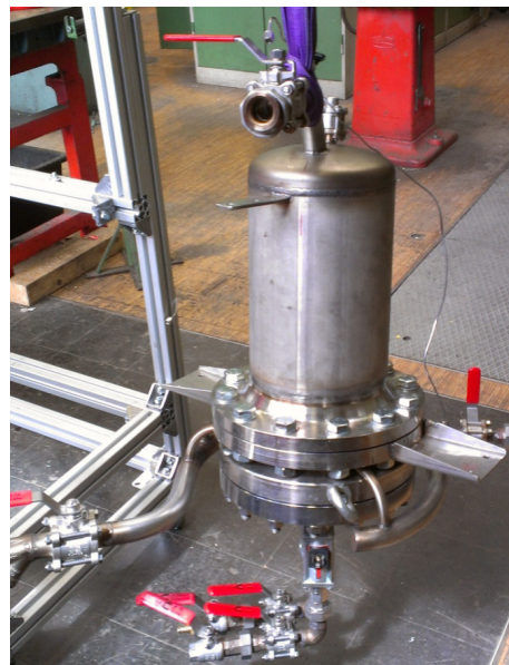
Abbildung 31: Fotos des ThermoPump-Funktionsmusters (Links: Zusammenbau und rechts fertiges Funktionsmuster) (Handler, 2012)
