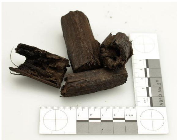
Abb. 7: Sonnenblume torr. (300°C 20 Min.)
