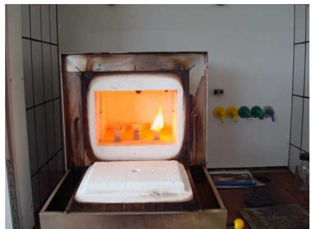
Abb. 9: Explosion im Muffelofen
