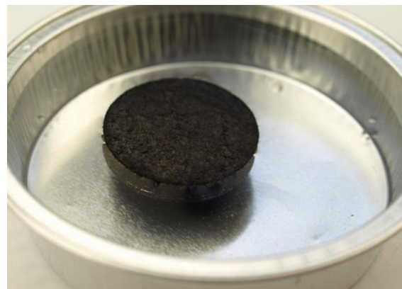
Abb. 12: Stark torr. Biomassepressling nach 30 min in Wasser
