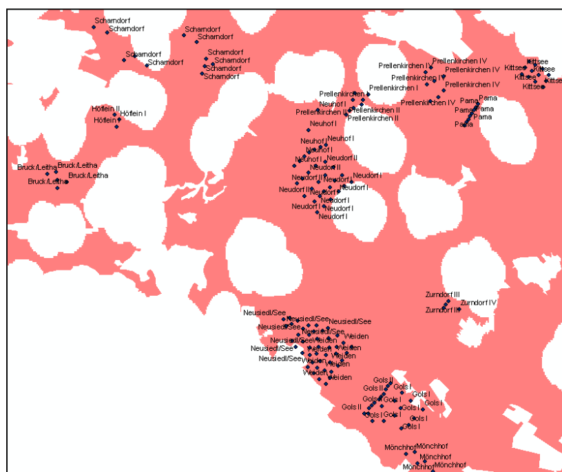
Abbildung 23: Verifikation der ermittelten Roh-Potenzialflächen für Wind unter technisch-rechtlichen Restriktionen; rot: Roh-Potenzialfläche, schwarze Punkte: reale WEA; Quelle: (Boxleitner, et al., 2010)
