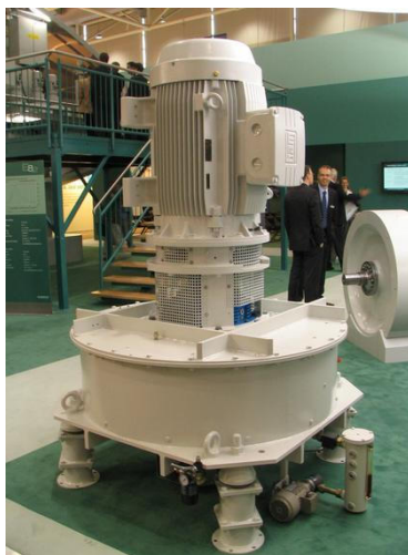
Abbildung 116: Schwungmassenspeicher mit einer Speicherkapazität von 5 kWh und 200 kW Spitzenleistung über 90 Sekunden. Er dient in Inselanlagen zum Ausgleich der schwankenden Windenergie
