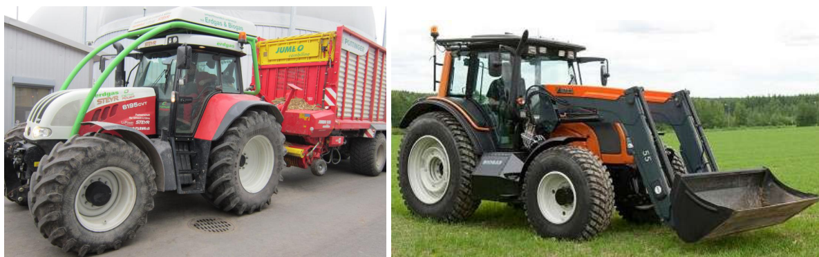
Abb. 25 Steyr-Traktor mit Nachrüstsatz zum Betrieb mit Biomethan/CNG-Anteil von ca. 65 %; Valtra aus Serienproduktion für Betrieb mit Biomethan/CNG-Anteil von ca. 80%
