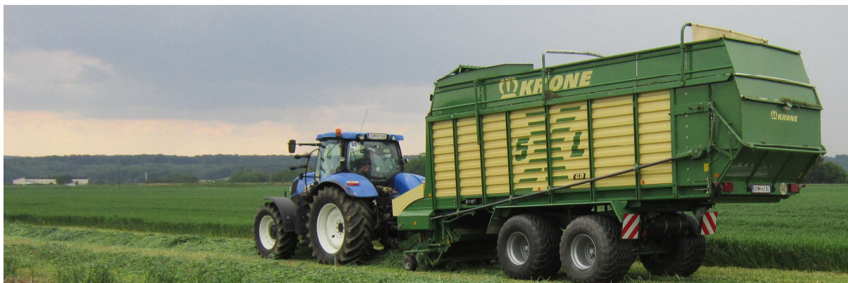
Abb. 23 Kurzschnittladewagen bei der Beerntung von Winter-ZF
