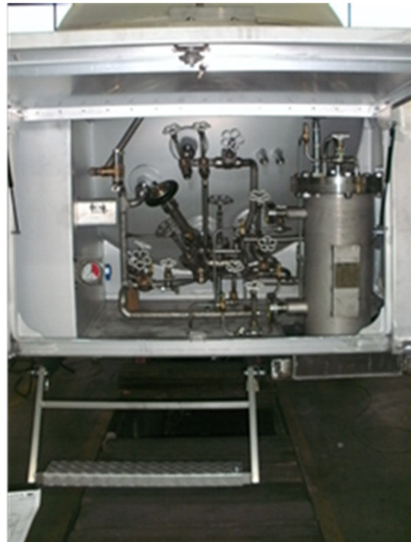
Abbildung 8 - Schaltschema des BioLNG Cryobehälters (links) und Armaturenschrank des Wechselcontainers (rechts)
