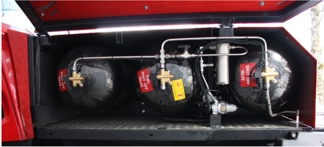
Abbildung 5 - Installierte Gastanks des Versuchsfahrzeugs
