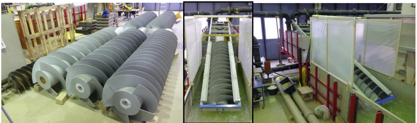
Abbildung 12: Gelieferte Schnecken (vorne 3,4, und 5-gängig), mit Trog und als fertiger Aufbau
