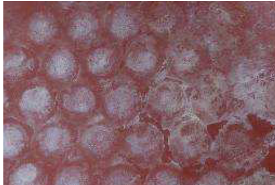
Abbildung 11: Silikonklappe nach Langzeitsprühversuch mit Ablagerungen
