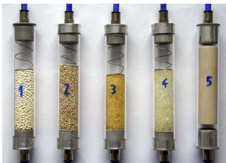
Abbildung 4: verschiedene Silikagelproben in Messröhrchen
