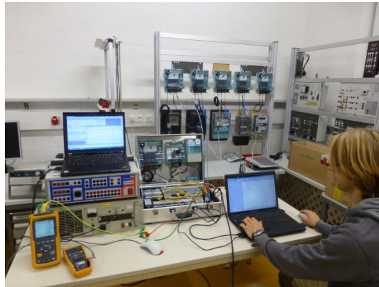
Abbildung 22: Testaufbau eines „Smart Emergency Grids“ im Smart-Grids-Labor des Instituts für Elektrische Anlagen mit AMIS-Smart Meter von Siemens
