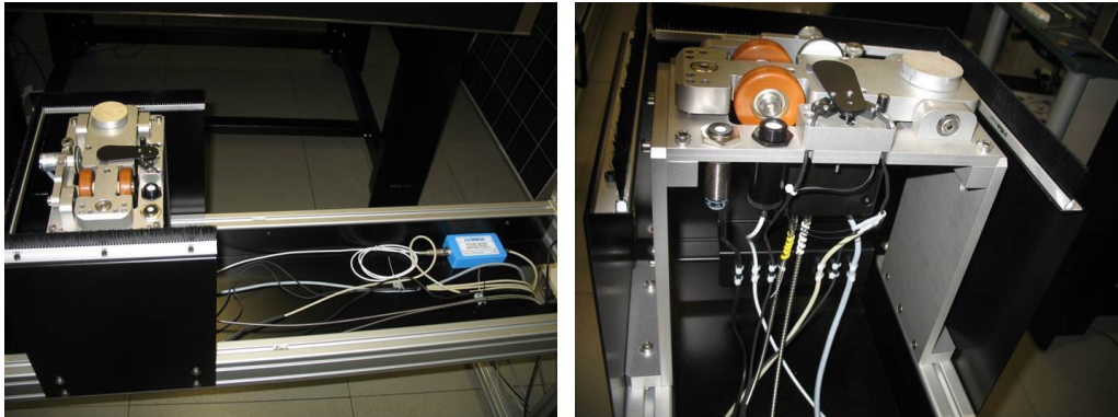
Abbildung 6: Aufbau Raman Messkopf mit Abstandshalter
