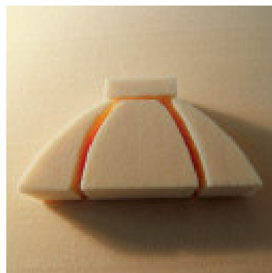
Abbildung 13 Anwendungen von PUR/PIR-Schäumen. Diese Materialien werden bereits zur Isolierung von Fernwärmeleitungen verwendet und können mechanisch gut bearbeitet werden (Schneiden, Fräsen, Thermoformen).
