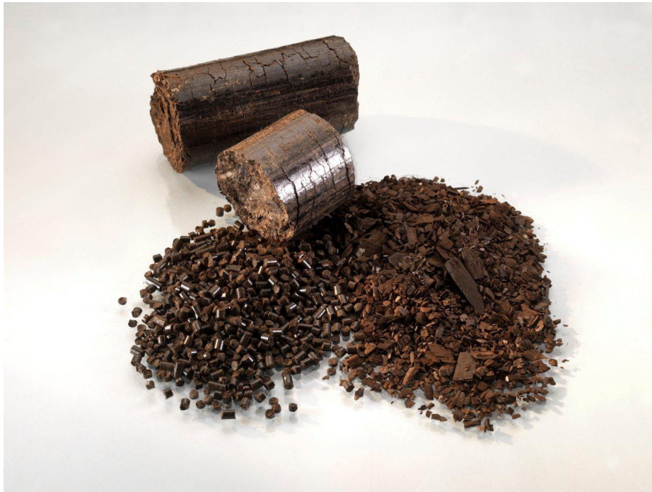
Abbildung 3: Torrefizierte Biomasse aus der ACB Pilotanlage in verschiedenen Aufbereitungsformen: lose, bri-kettiert und pellettiert
