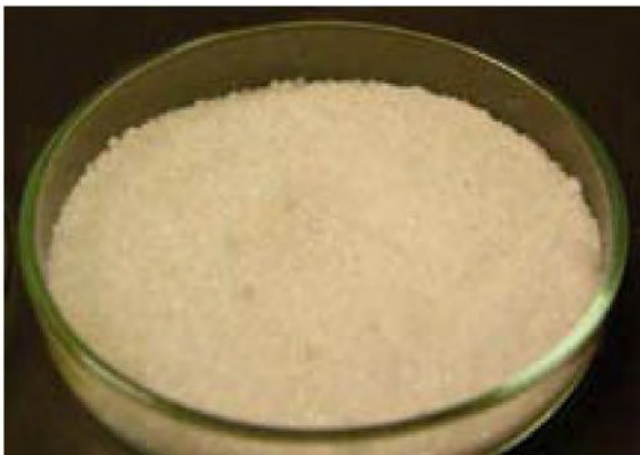
Abbildung 28: Probe Magnesiumsulfat-Pulver – eines der thermochemischen Materialien, die untersucht werden.
