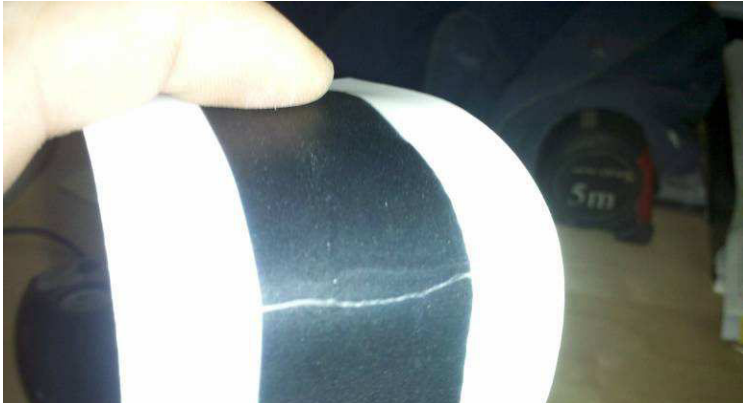
Abb 18: Bruch des beschichteten Edelstahlsubstrats der Sunplugged Solarzelle bei Verkapselung
