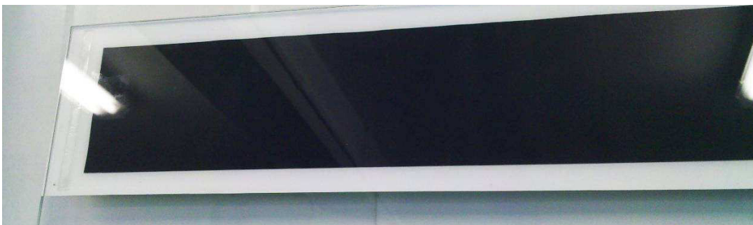
Abb 19: Bruchfreie Lamination der Dünnschichtsolarfolien
