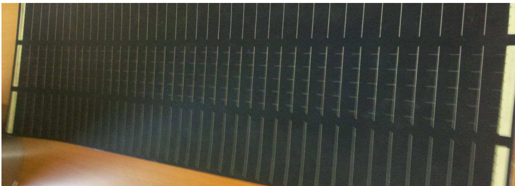
Abb 20: 300 mm breites Anschauungsmodul (vorgestellt auf der Intersolar 2011) der SimpliCIS Technologie. Das Anschauungsmodul enthält alle funktionalen Schichten (außer den CIGS Absorber) und die gedruckte Kontaktierung.
