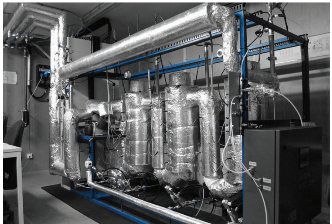
Abb. 2: Versuchsanlage zur schwefelresistenten Katalyse am Gelände des Biomassekraftwerkes Oberwart
