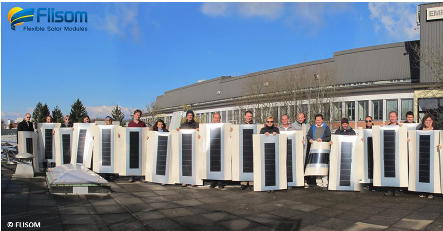
Abbildung 6: mit dem neuen Hochbarrierematerial und im Rolle-zu-Rolle-Prozess eingekapselte CIGS-Module.
