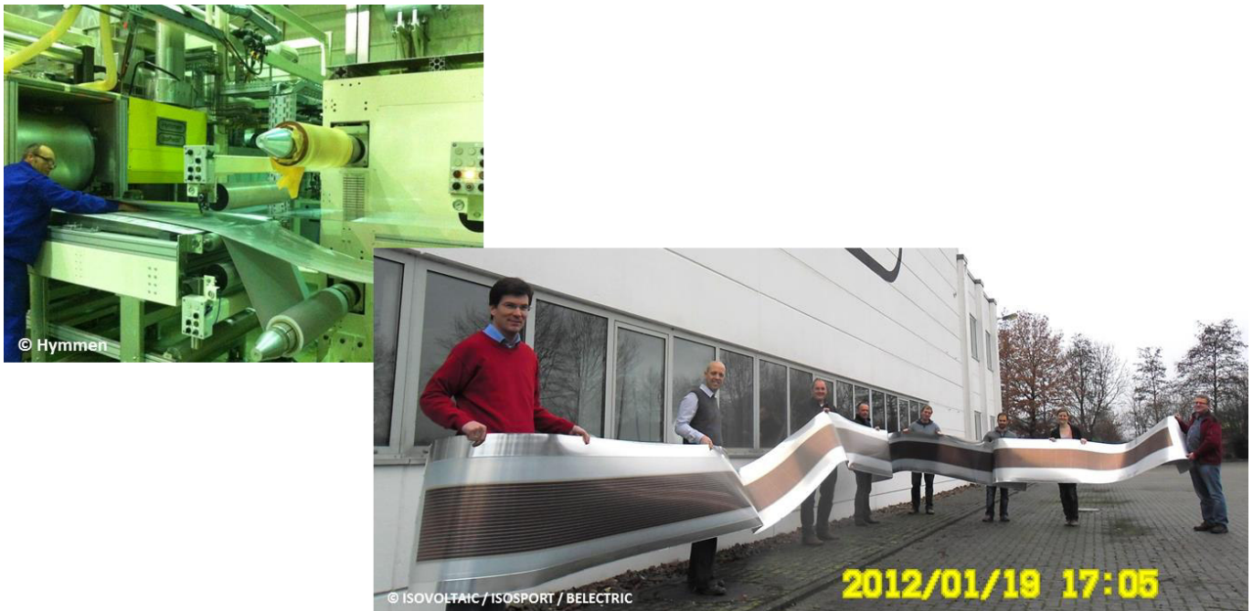
Abbildung 5: Fertigung von flexiblen PV-Modulen / flexibles PV-Modul aus R2R-Prozess
