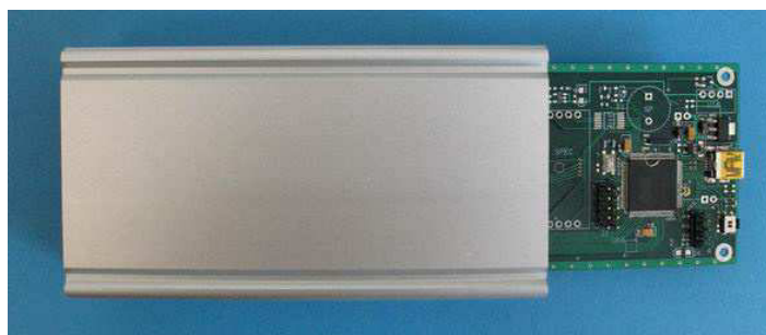
Abbildung 3: Teilweise bestückte LimeSpec Leiterplatte in einem LimeSpec Roh-Gehäuse
