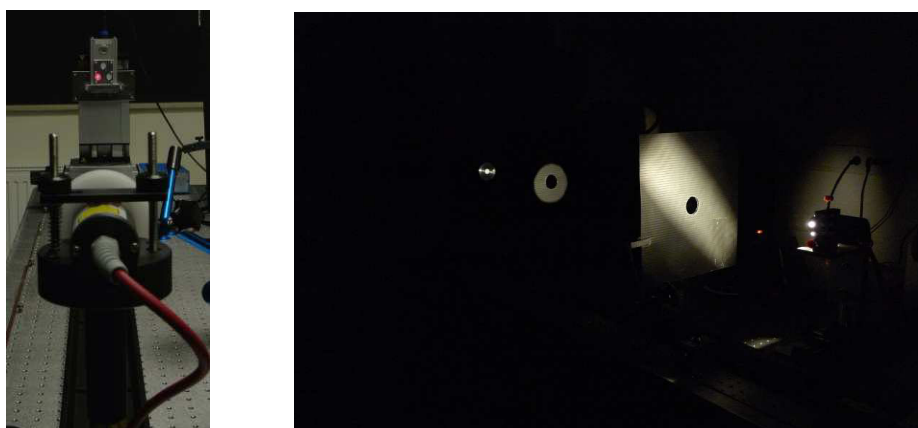
Abbildung 12: Justage von LimeSpec mit Hilfe des Lasers (links). Messaufbau mit Blenden zur Vermeidung von Streulicht bei der Messung mit einem Referenzgerät (rechts).
