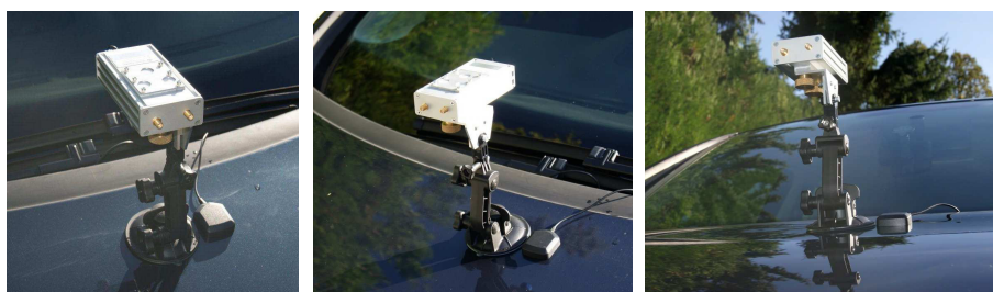
Abbildung 14: LimeSpec auf Fahrzeug montiert (3 Bilder)
