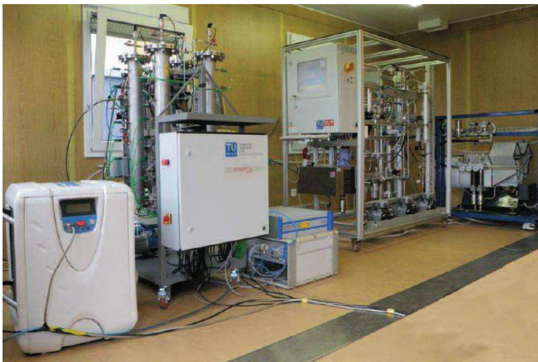
Abbildung 20: Fotografie der ersten Prozesskette zur Wasserstoffherstellung in Oberwart. Von links nach rechts: PEM Brennstoffzelle, DWA, Membraneinheit mit Kompressor. Der RME Wäscher befindet sich im Stahlbau im Kraftwerk (Diaz, 2013).
