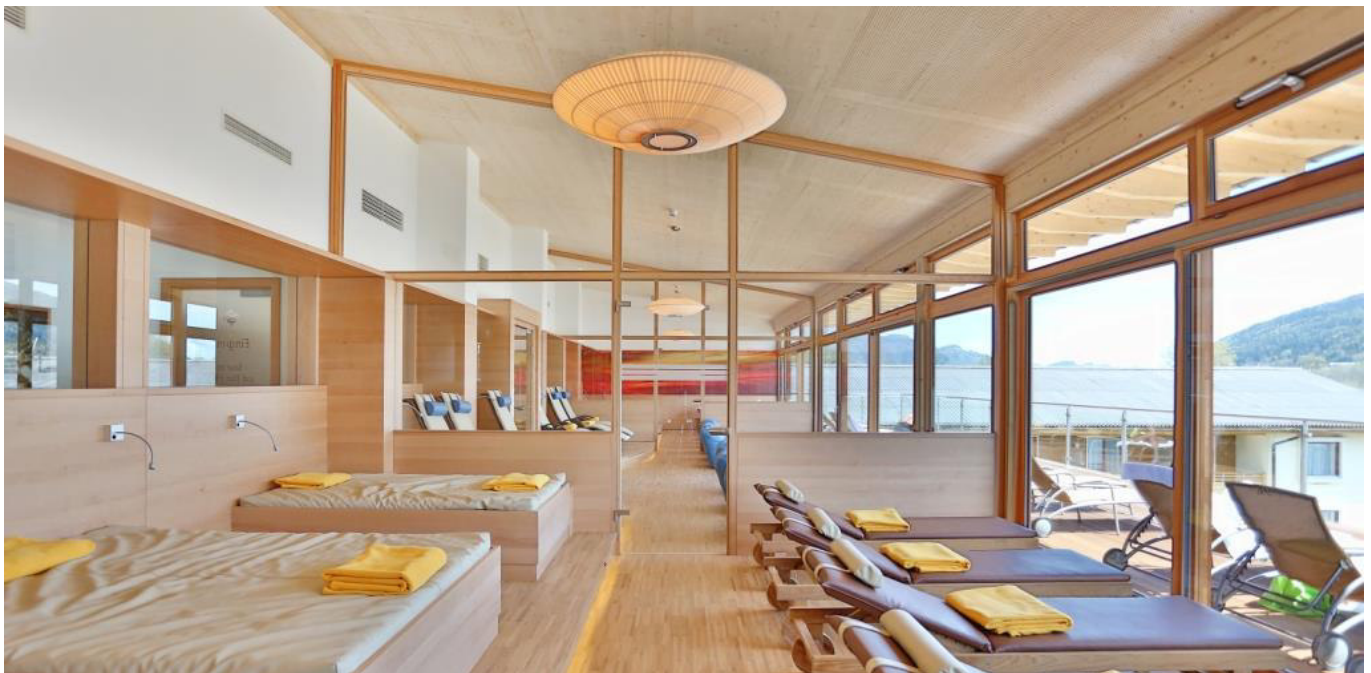
Abbildung 49: Ruheraum im „Wellnesspenthause - Hotel SeeRose“ in reiner Holz- und Niedrig Bauweise – die gesamte Südfront wurde aufgeglast – das weitausladende Vordach schützt vor Überhitzung im Sommer
