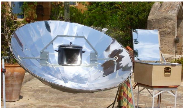
Abbildung 46: Ein Solarofen, wie er von verschiedenen Herstellern angeboten wird, könnte als Zusatzheizung und „Wasserverdampfer“ für eine Biosauna dienen.
