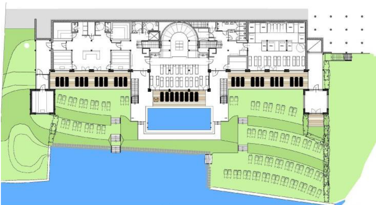
Abbildung 36: Untergeschoß des „Kärntner Badehauses“ mit Saunanlage, Ruheräume und beheiztem Außenpool
