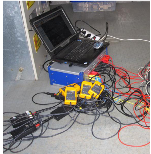
Abbildung 4: Messwertaufnehmer am Niederspannungsabgang links, 16-Kanal Messsystem rechts
