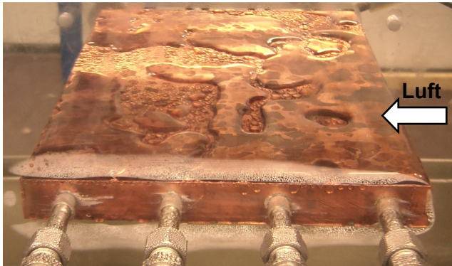
Abbildung 6: Kupferplatte während eines Kondensationsvorganges
