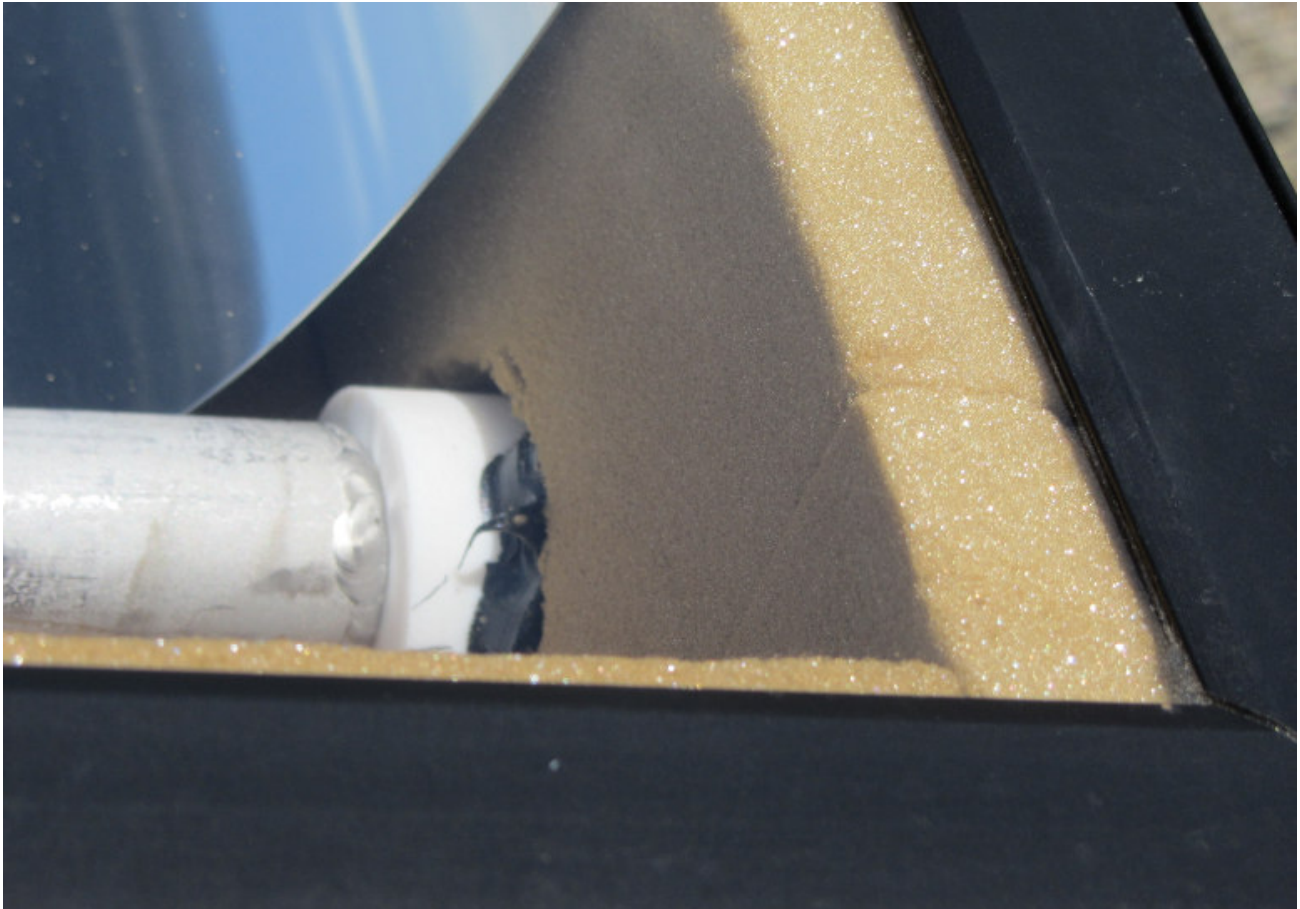
Abbildung 31: Detailaufnahme der Isolierung des PT1 nach der Vermessung.
