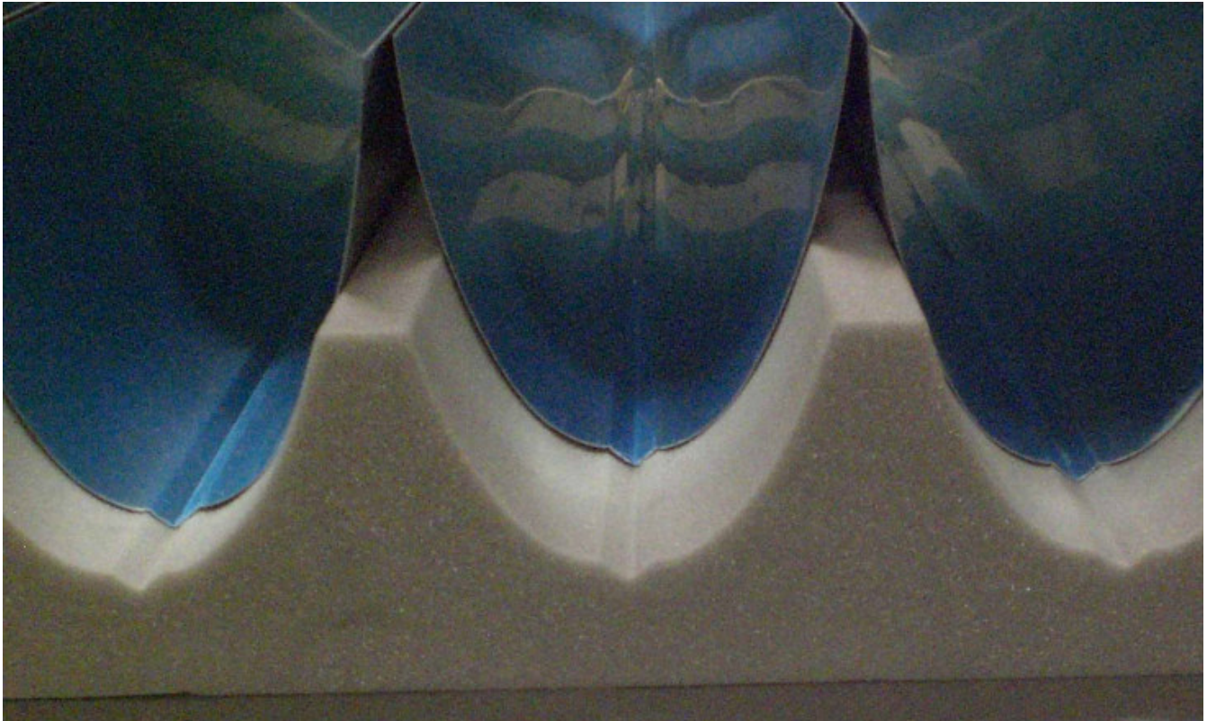
Abbildung 28: Spiegel und angepasste Isolierung des PT2013.
