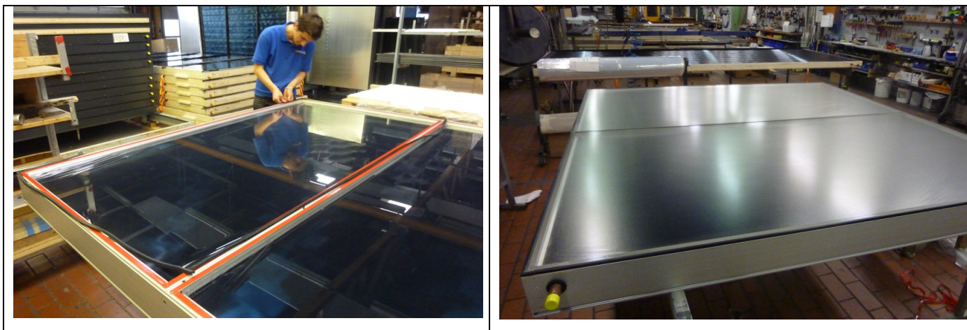
Abbildung 19: links: Einsetzen der EPDM Dichtungen (Folie bereits montiert), rechts: fertiger Kollektor – Entwicklungsstufe IV
