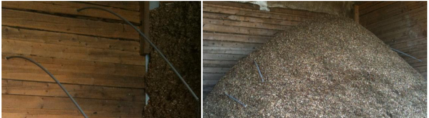
Abbildung 1-3 Anbringung der Messtechnik an der Trockenboxrückwand
