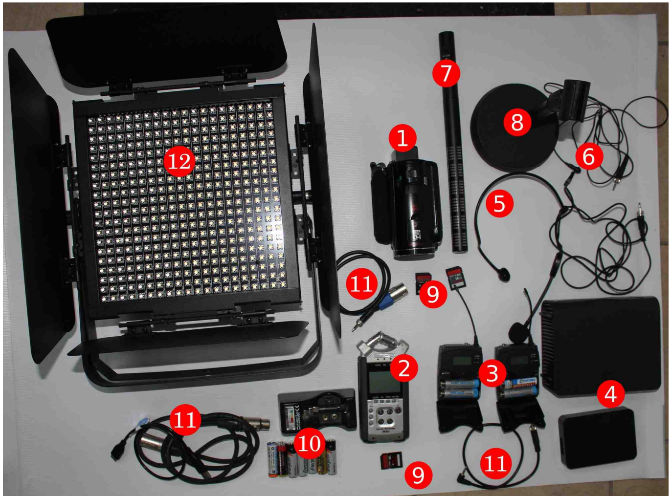
Abbildung 11: Wesentliche Elemente des verwendeten Video- und Audioequipments: Kamera HD Camcorder Canon Legria (1), Audiorekorder Zoom H4N (2), Funkmikrofonset (Empfänger und Sender) (3), externe Festplatten (4), Headsetmikrofon (5), Ansteckmikrofon (6), Tischmikrofon (7) und Mikrofonständer (8), Speicherkarten (9), Batterien und Batteriemessgerät (10), diverse Kabel (11), LED-Flächenleuchte (12).
