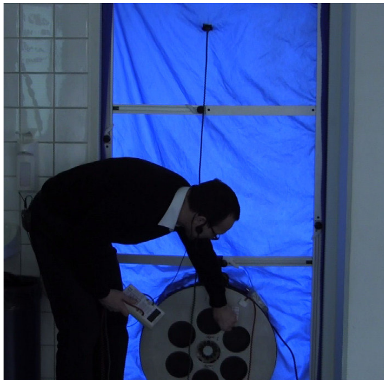
Abbildung 8: Demonstration einer Luftdichtheitsmessung durch Emanuel Panic während der Fortbildungsveranstaltung in Wien.
