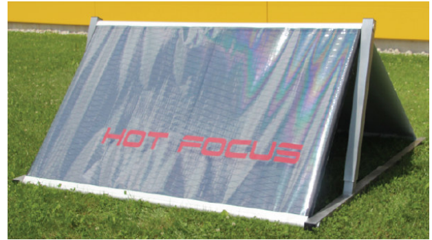
Abb. 3-1: CAD-Zeichnung (links) und realisiertes Modell (rechts) des Folienkollektorkonzeptes „Greiner HotFocus“.
