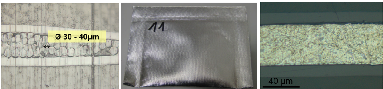
Abb. 3-3: Querschliffe oder Funktionsmuster einer Faserbündel-verstärkten Frontseitenfolie (links), einer Absorber-Hybridfolie (Mitte) und eines Reflektor-Folienlaminats (rechts).
