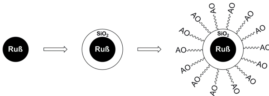
Abb. 4-2: Schematische Darstellung der Bildung sphärischer AO-funktionalisierter RuB-Siliziumdioxid Kern/Schale-Partikel.
