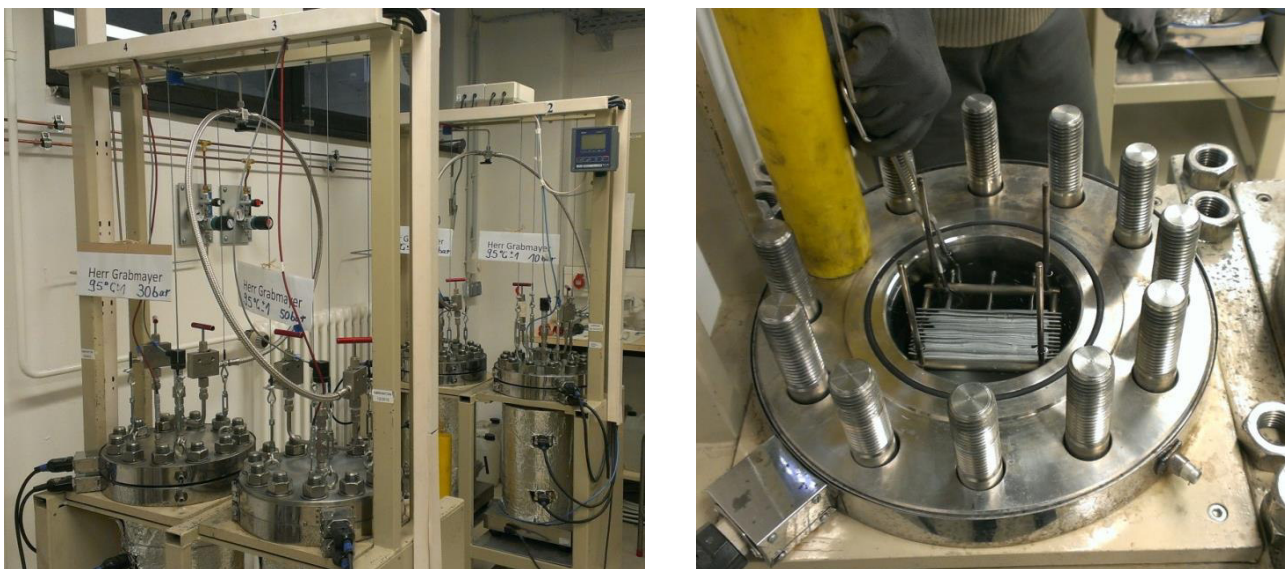
Abb. 5: Autoklaven zur Lagerung in Wasser bei variierbarem Sauerstoff-Partialdruck; Quelle: Dr. Ulrike Braun, BAM Berlin/D
