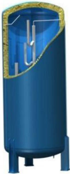
Abbildung 2-2: Schema Vakuumpufferspeicher der Firma Hummelsberger (Hummelsberger, 2010)
