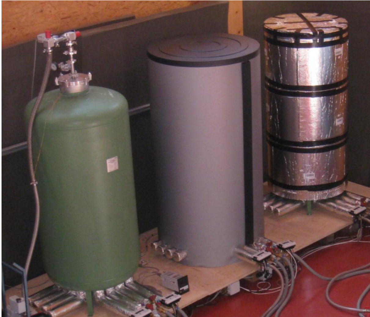
Abbildung 3-14: Thermoskannenspeicher (links), Referenzspeicher: Standardspeicher mit PU-Weichschaumdämmung (mitte), Standardspeicher mit VIP's (rechts)
