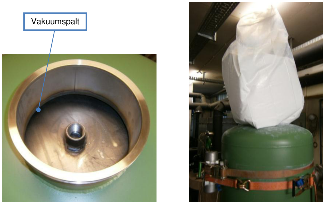
Abbildung 3-13: Befüllung des Thermoskannenspeichers am Technikum von JOANNEUM RESEARCH in Graz (rechtes Bild: Befüllöffnung an der Oberseite des Speichers, linkes Bild: Befüllvorgang mit Hilfe eines Rüttlers der Fa. Wacker)
