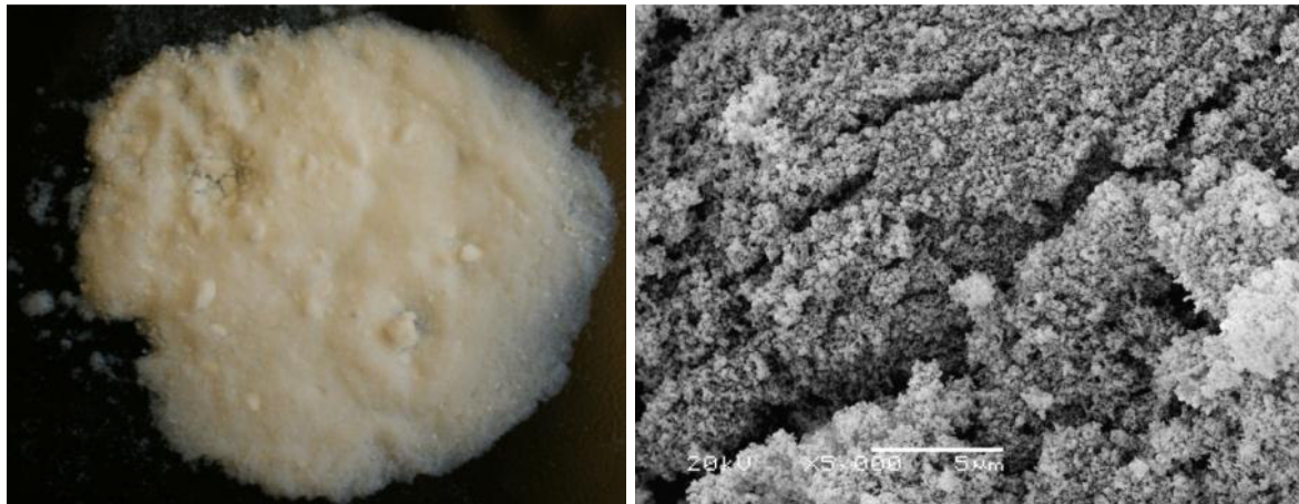
Abbildung 2-5: Opakes Schüttmaterial HDK T30 der Firma Wacker Chemie AG
