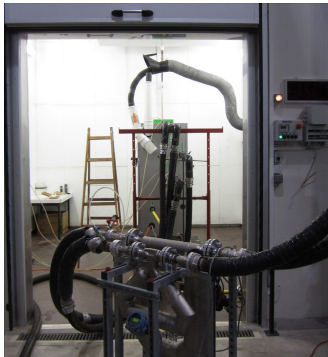
Abbildung 4: Alpha-Anlage während der Normmessungen in einer der Klimakammern am AIT. Im Vordergrund befinden sich die Coriolos-Massenstromsensoren zur Erfassung der Nutzer- und Quellenseitigen Massenströme.
