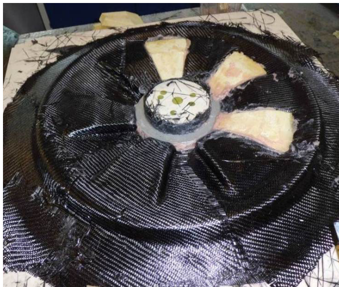
Abb. 13: Teilweise laminierte Schale aus CFK-Epoxy mit Sandwich-Schaumkernen auf Laminiervorrichtung
